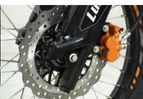
FRENO A DISCO DELANTERO Y TRASERO
